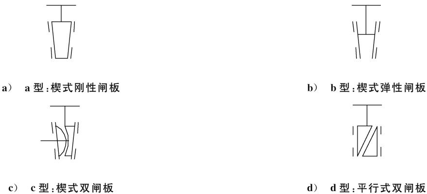
图 3 闸板的结构
