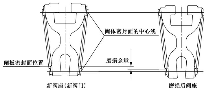
图4 闸板密封面磨损余量示意图
